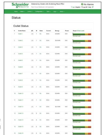
アウトレット単位の電流と電力ステータス表示画面 (Metered Plus、Switched Plusのみ)
